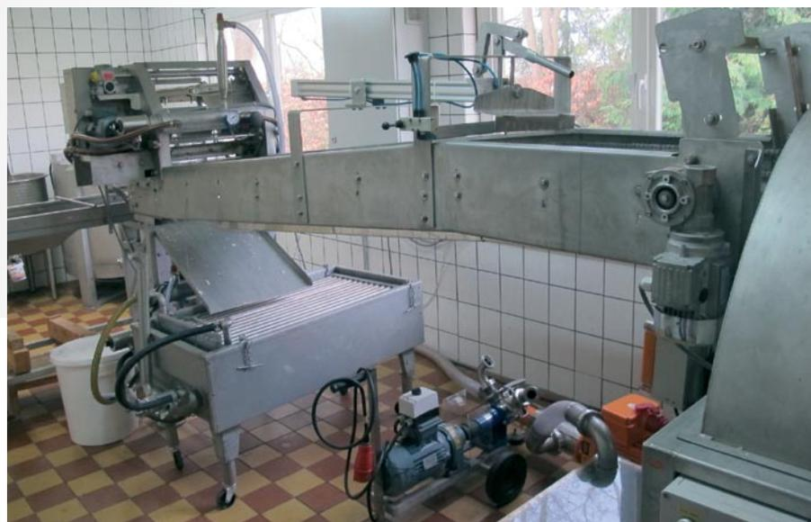
On y découvre une longue chaîne d'extraction Keller. Il était le premier à avoir ce prototype qui a aujourd'hui six ans. Il permet à une personne d'extraire 1,5 t en 8 heures. L'extracteur de 60 cadres a un couvercle à ouverture pneumatique. Le cycle d'extraction est entièrement programmé en fonction du miel à extraire. La production annuelle varie de 15 à 30 t.
