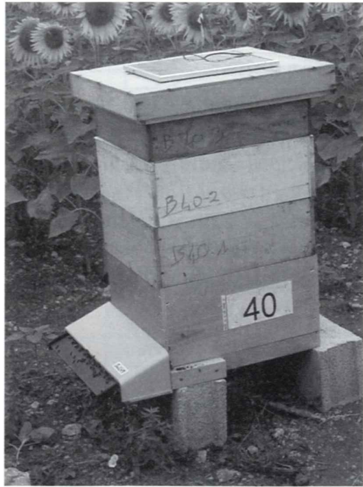
Détail qui montre la façon dont est placé le compteur d'activité sur la planche d'envol. Aucune abeille ne peut l'éviter. Une aération par le sol est prévue de manière à assurer une bonne ventilation de la ruche dans cette région chaude (Sud de la France). Ceci permet d'éviter la formation d'une barbe d'abeilles qui risquerait de perturber les mesures. On peut voir sur la photo le panneau solaire sur le toit qui assure l'alimentation énergétique de l'appareil (30mA). Ce panneau est relié à une batterie de 12 V sous la ruche (non visible sur la photo).
