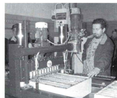
Désoperculeuse en fonctionnement
