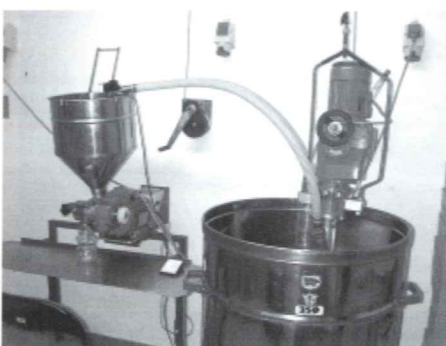
Pompe doseuse + mise en pots
