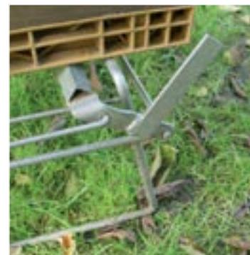
Un manche équipé d'un dynamomètre s'emboîte sur le levier soudé à la partie mobile du support. Lorsqu'on soulève la ruche, le dynamomètre donne une évaluation du poids.
