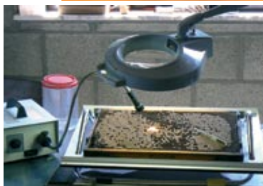
Fig.3 : Matériel pour l'observation, loupe grossissement 2.5, lampe fibre optique et brucelles
