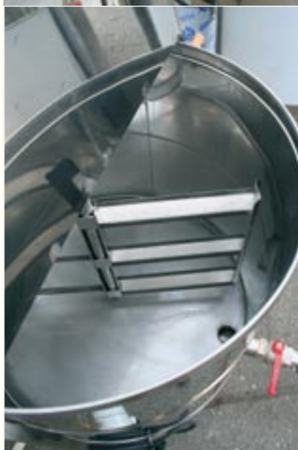
Malaxeur à motorisation manuelle ou électrique
